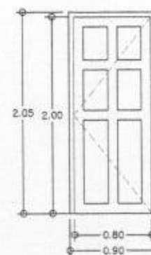
D4 วงกบไม้เนื้อแข็ง 2" X 4" กรอบบานไม้ 1/4" X 4"
