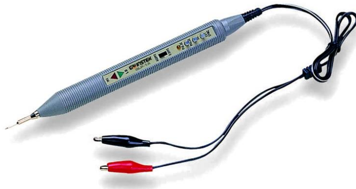
รูปที่ 1.3 ลอจิกโพรบที่ใช้วิเคราะห์วงจรดิจิทัล
